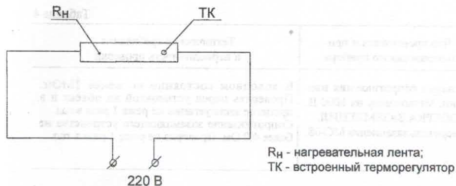
Рис.10. Схема электрическая принципиальная с применением встроенного терморегулятора (ТК).
