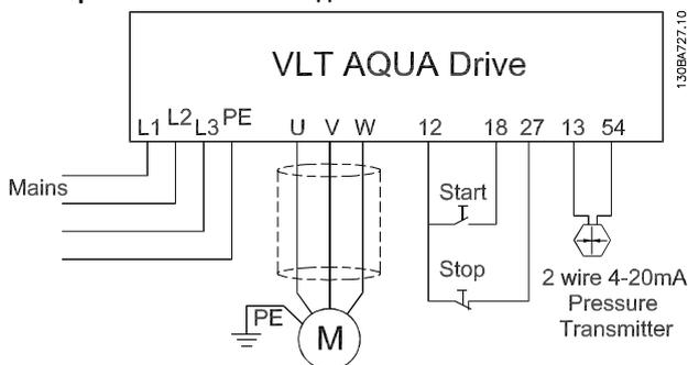
Рисунок 4.7 Проводка в системах с погружным насосом
