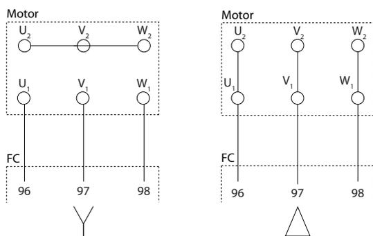
Рисунок 8.10 Подключения по схемам «звезда» и «треугольник»
