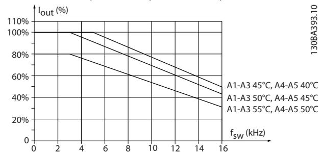
Рисунок 5.3 Снижение  $I_{вых.}$  при различных значениях  $T_{ОКР. СР., МАКС.}$  для корпусов размера А и модели коммутации  $60^{\circ}$  AVM
