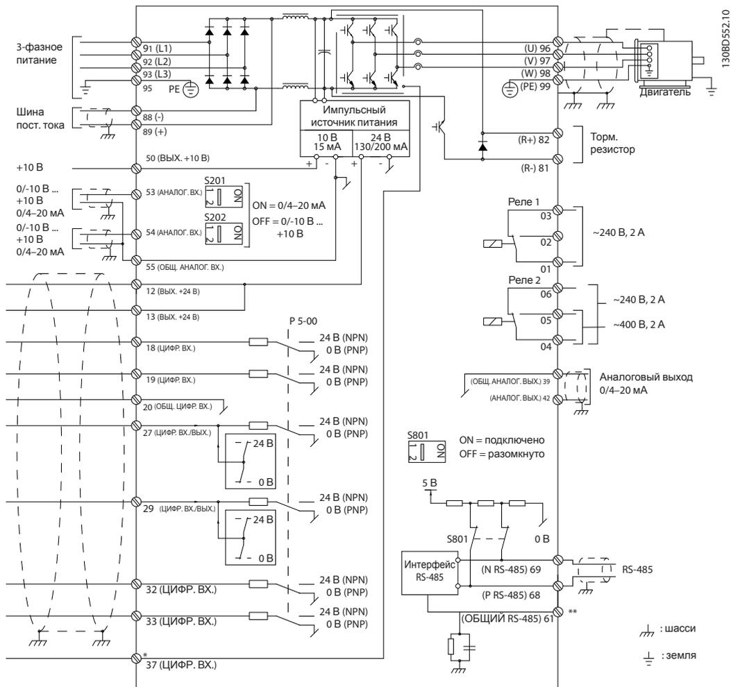
Рисунок 3.20 Схема основных подключений
