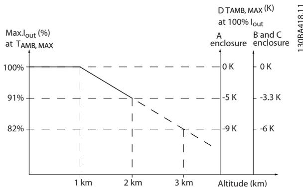
Рисунок 5.1 Снижение номинального выходного тока в зависимости от высоты над уровнем моря при температуре окружающей среды  $T_{\text{окр. ср.}}$ , макс. для корпусов размера A, B и C
