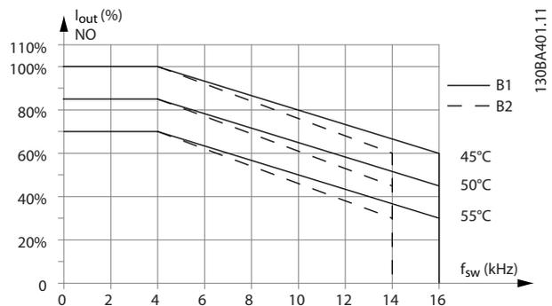
Рисунок 5.7 Снижение  $I_{\text{вых.}}$  при различных значениях  $T_{\text{окр. ср., макс.}}$  для корпусов размера В1 и В2, при использовании модели коммутации 60° AVM в режиме нормальной перегрузки (перегрузка по крутящему моменту 110 %)
