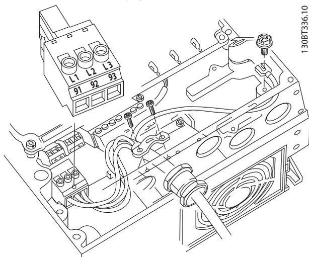
Рисунок 8.2 Сеть и заземление без разъединителя
