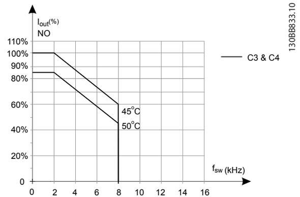
Рисунок 5.18 Снижение  $I_{\text{вых.}}$  при различных значениях  $T_{\text{окр. ср., макс.}}$  для корпусов размера С3 и С4, при использовании модели коммутации SFAVM в режиме нормальной перегрузки (крутящий момент 110 %)
