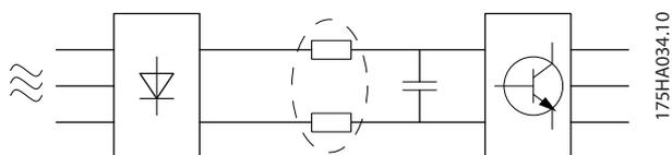
Рисунок 3.3 Катушки индуктивности промежуточной цепи
