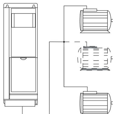
Рисунок 3.11 Подключение общим жгутом для кабелей малой длины
