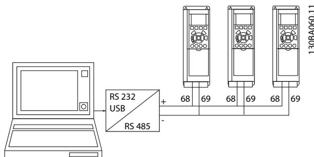
Рисунок 3.41 Параллельные соединения
