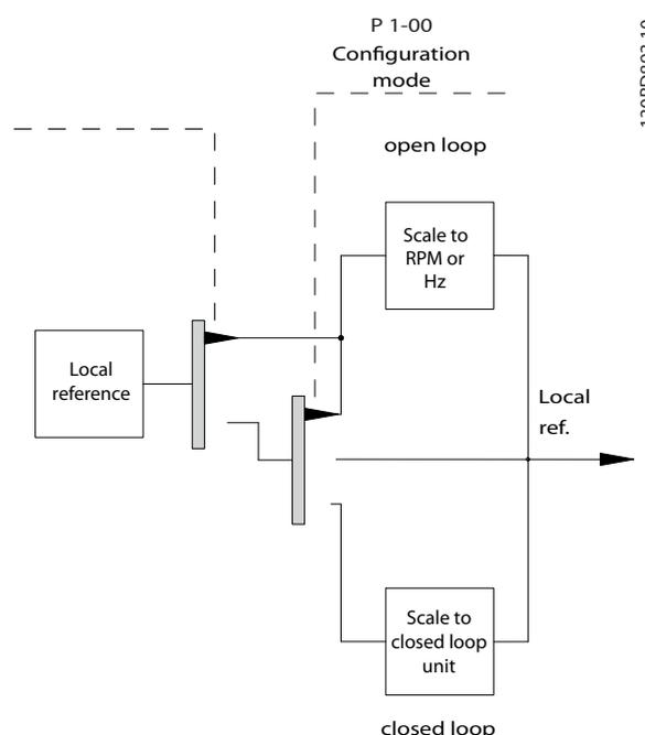
Рисунок 2.14 Режим конфигурирования
