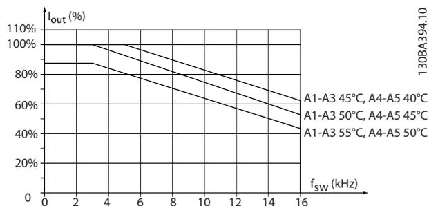
Рисунок 5.5 Снижение  $I_{\text{вых.}}$  при различных значениях  $T_{\text{окр. ср., макс.}}$  для корпусов размера А, при использовании модели коммутации 60° AVM и кабеля двигателя длиной не более 10 м
