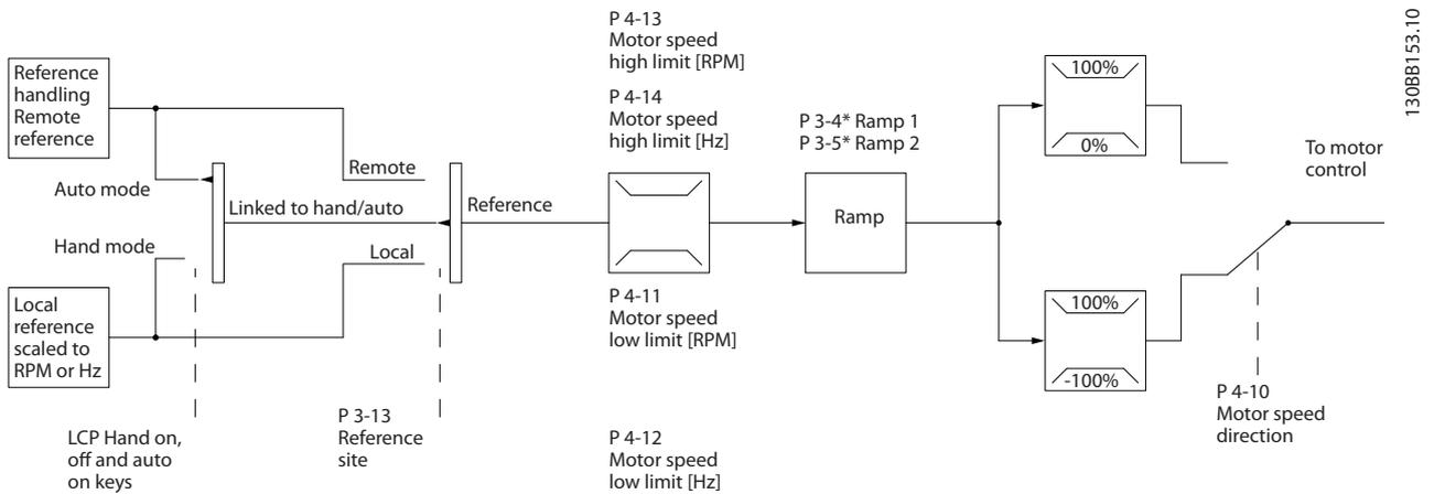
Рисунок 2.11 Блок-схема режима без обратной связи
