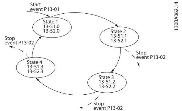
Рисунок 2.20 Порядок выполнения, если запрограммировано 4 события/действия
