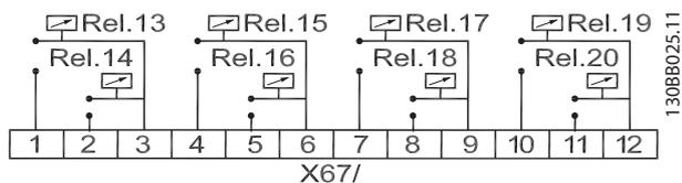
Рисунок 7.19 Клеммы подключения Advanced Cascade Controller MCO 102, 8 реле
