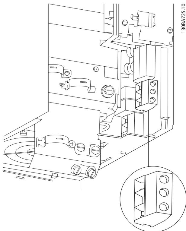
Рисунок 8.5 Подключение сети, корпус В3
