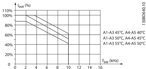
Рисунок 5.6 Снижение  $I_{\text{вых.}}$  при различных значениях  $T_{\text{окр. ср., макс.}}$  для корпусов размера А, при использовании модели коммутации SFAVM и кабеля двигателя длиной не более 10 м
