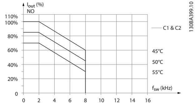
Рисунок 5.17 Снижение  $I_{\text{вых.}}$  при различных значениях  $T_{\text{окр. ср., макс.}}$  для корпусов размера С1 и С2, при использовании модели коммутации SFAVM в режиме нормальной перегрузки (крутящий момент 110 %)
