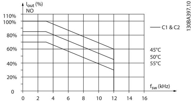
Рисунок 5.15 Снижение  $I_{\text{вых.}}$  при различных значениях  $T_{\text{окр. ср., макс.}}$  для корпусов размера С1 и С2, при использовании модели коммутации 60° AVM в режиме нормальной перегрузки (перегрузка по крутящему моменту 110 %)
