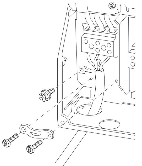
Рисунок 8.4 Подключение сети, корпуса B1 и B2
