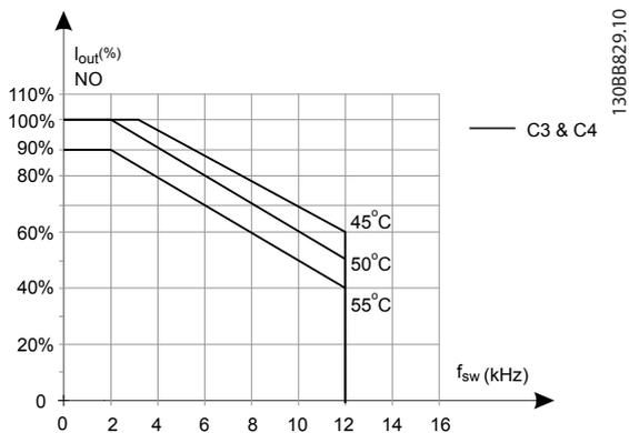
Рисунок 5.16 Снижение  $I_{\text{вых.}}$  при различных значениях  $T_{\text{окр. ср., макс.}}$  для корпусов размера С3 и С4, при использовании модели коммутации 60° AVM в режиме нормальной перегрузки (крутящий момент 110 %)
