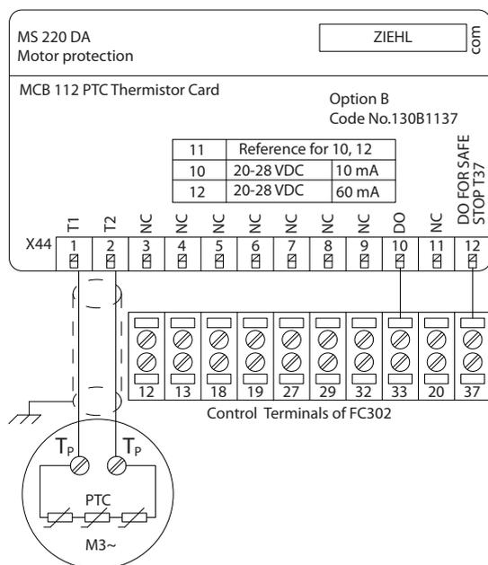
Рисунок 7.9 Монтаж MCB 112
