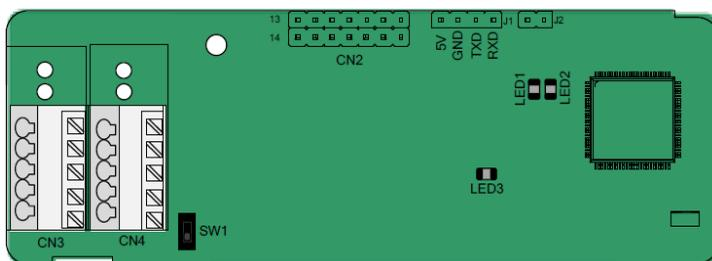
DIP-переключатель SW1 используется для установки класса напряжения (5 В или 12 В) источника питания энкодера. DIP-переключателем можно управлять с помощью вспомогательного инструмента.
