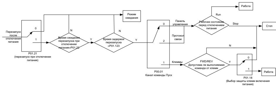
(3) Логическая схема для перезапуска после автоматического сброса ошибки
