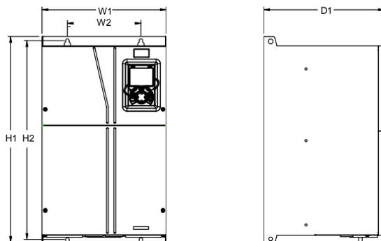
Рисунок С.6 Схема настенного монтажа приводов 090G/110P-110G/132P
