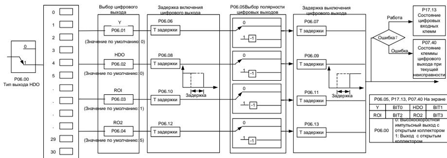
В приведенной ниже таблице перечислены параметры для вышеуказанных четырех параметров функции, и пользователям разрешено многократно выбирать одни и те же функции выходных клемм.
