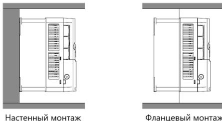
Рис 4.2 Способы установки
