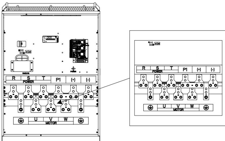
Рис 4.12 Диаграмма силовых клемм для моделей 220G/250P–315G/355P
