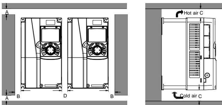
Рис 4.4 Параллельная установка
