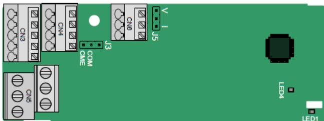
COM и SME по умолчанию замкнуты на разъеме J3, а J5 - это перемычка для выбора типа выхода (напряжение или ток) AO2.
