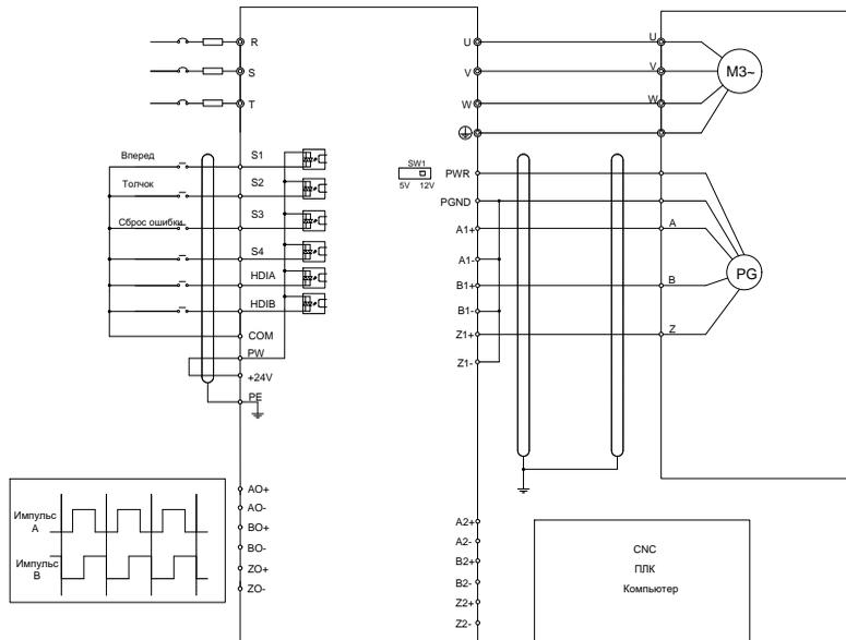
На следующем рисунке показано внешнее подключение платы расширения, используемой в сочетании с двухтактным датчиком.
