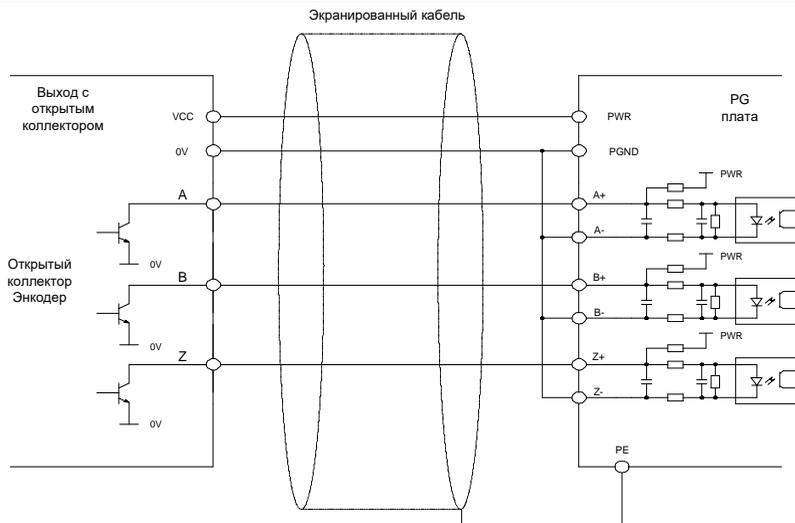
На следующем рисунке показано внешнее подключение платы расширения, используемой в сочетании с двухтактным датчиком.
