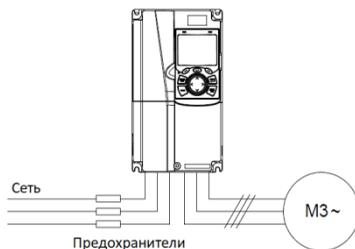
Рис 4.19 Подключение предохранителей
