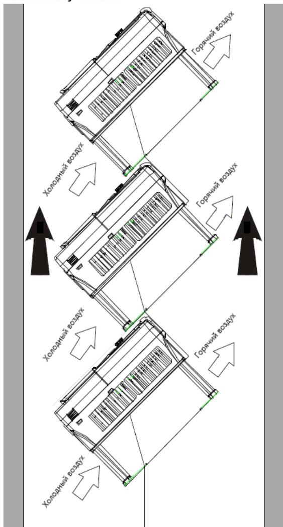
Рис 4.6 Наклонная установка
