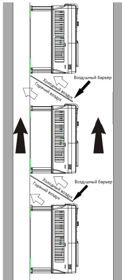
Рис 4.5 Вертикальная установка
