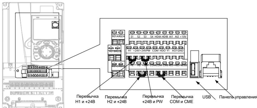
Рис 4.16 Расположение U-образных контактов
