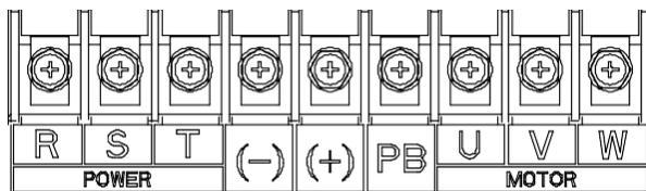
Рис 4.10 Диаграмма силовых клемм для моделей 045G/055P-110G/0132P
