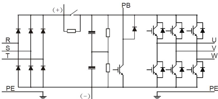
Рис 3.1 Схема силовой цепи 015G/018P и ниже
