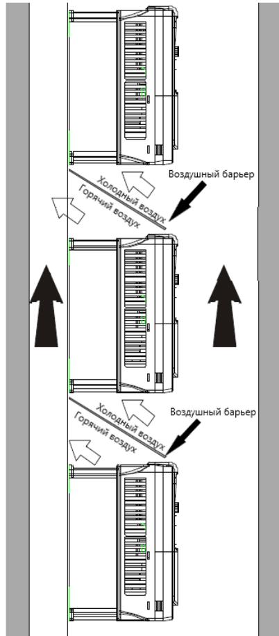
Рис 4.5 Вертикальная установка
