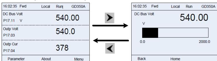
Рис 5.6 Отображение стилей параметров в рабочем режиме
