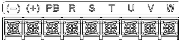
Рис 4.9 Диаграмма силовых клемм для моделей 030G/037P-037G/045P
