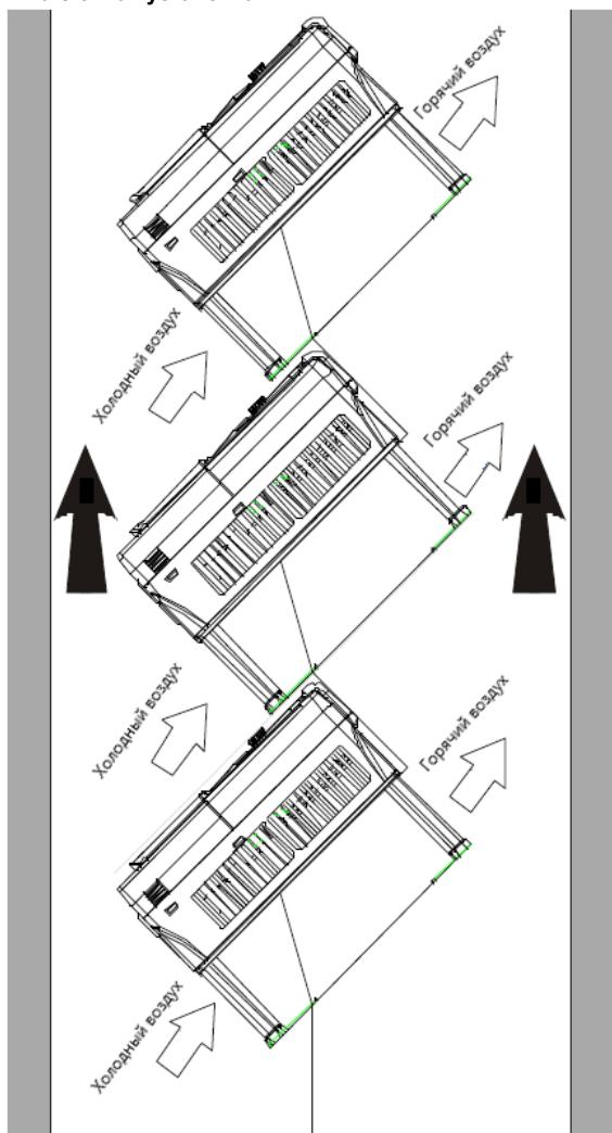
Рис 4.6 Наклонная установка
