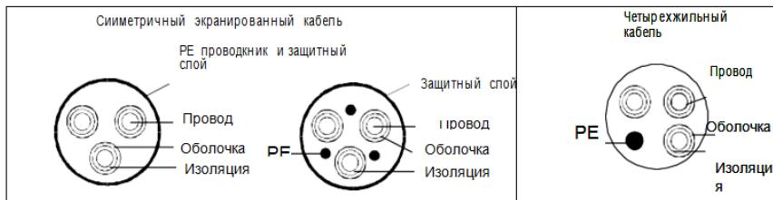
**Примечание:** Если проводимость экранирующего слоя кабелей двигателя не может соответствовать требованиям, необходимо использовать отдельные провода PE.
