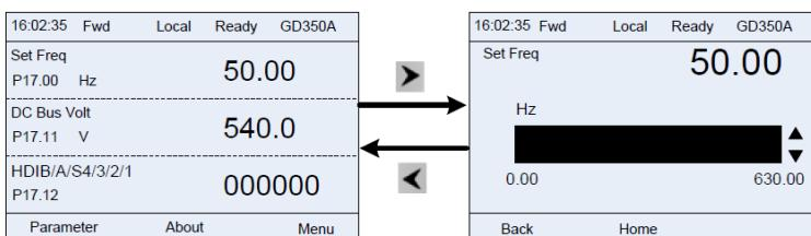
Рис 5.4 Окно 2 отображения параметров в режиме останова
