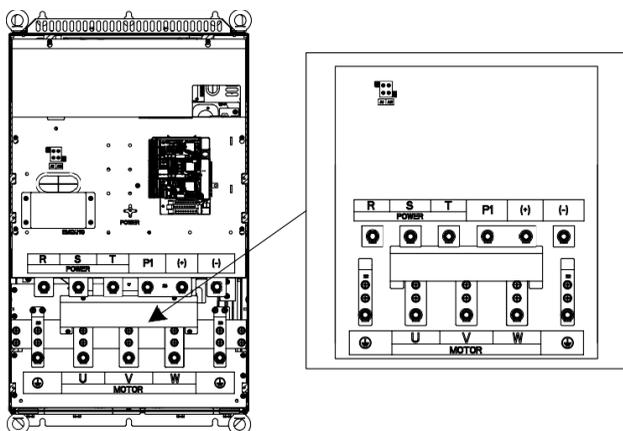
Рис 4.11 Диаграмма силовых клемм для моделей 132G/160P-200G/220P
