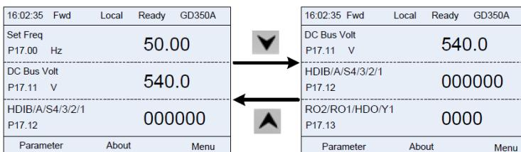
Рис 5.3 Окно 1 отображения параметров в режиме останова
