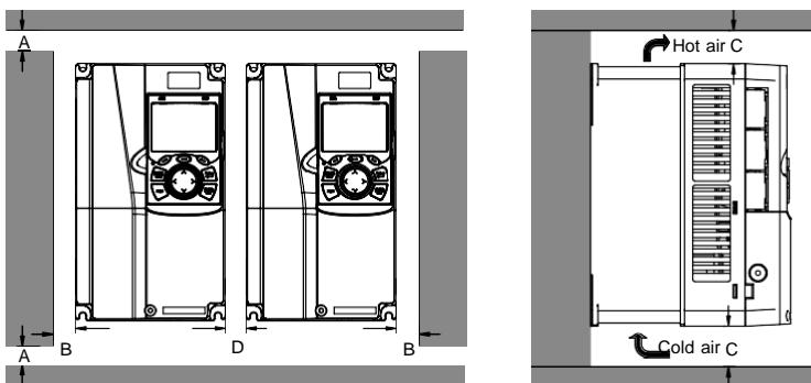
Рис 4.4 Параллельная установка
