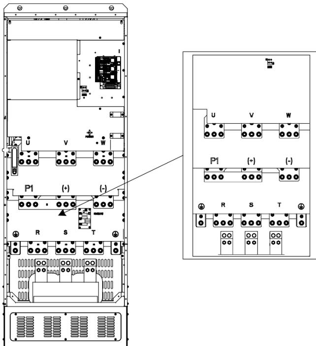
Рис 4.13 Диаграмма силовых клемм для моделей 355G/400P–500G
