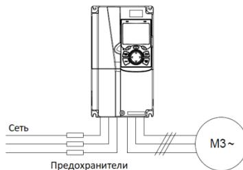
Рис 4.19 Подключение предохранителей
