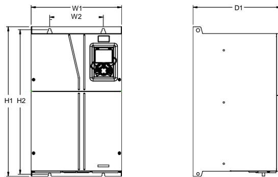
Рисунок С.6 Схема настенного монтажа приводов 090G/110P-110G/132P
