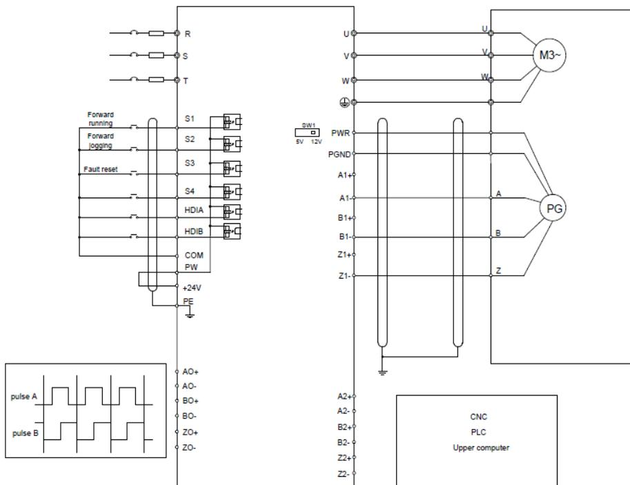
На следующем рисунке показано внешнее подключение платы расширения, используемой в сочетании с дифференциальным энкодером.
