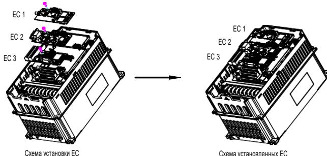
Рис А.1 ПЧ 7,5 кВт или выше с установленными платами расширения
