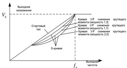
ПЧ серии GD350A также обеспечивает многоточечную кривую U/F. Пользователи могут изменять кривую U/F, выводимую ПЧ, путем установки напряжения и частоты трех точек в середине. Вся кривая состоит из пяти точек, начиная с (0 Гц, 0 В) и заканчивая (номинальная частота двигателя, номинальное напряжение двигателя). Во время настройки требуется, чтобы  $0 \leq f_1 \leq f_2 \leq f_3 \leq$  Основная частота двигателя; и  $0 \leq V_1 \leq V_2 \leq V_3 \leq$  Номинальное напряжение двигателя.
