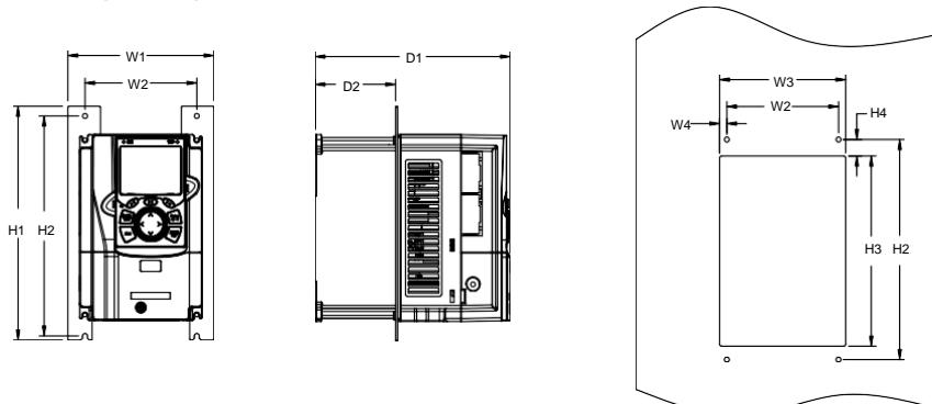
Рисунок С.9 Схема фланцевого монтажа приводов 1R5G/2R2P-075/090P
