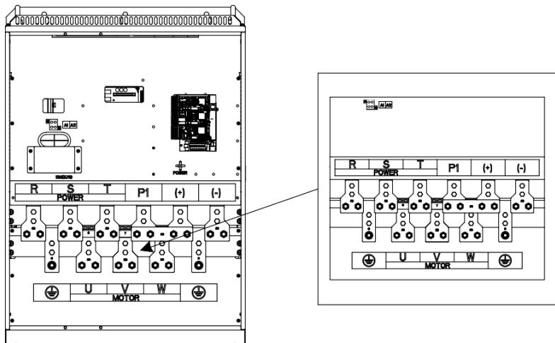
Рис 4.12 Диаграмма силовых клемм для моделей 220G/250P–315G/355P
