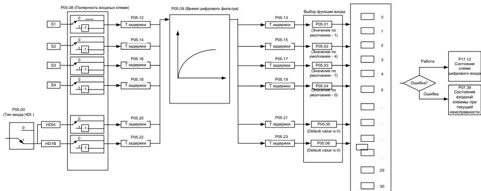
Эти параметры используются для установки соответствующей функции цифровых многофункциональных входных клемм.
