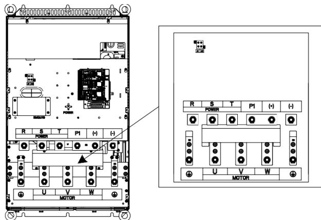
Рис 4.11 Диаграмма силовых клемм для моделей 132G/160P–200G/220P
