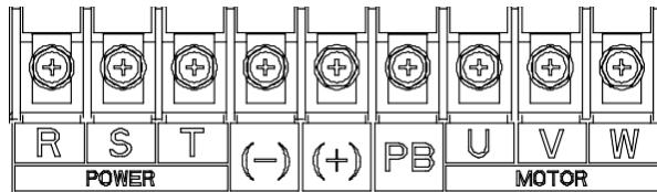
Рис 4.10 Диаграмма силовых клемм для моделей 045G/055P–110G/0132P
