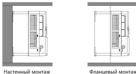
Рис 4.2 Способы установки
