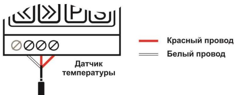
Рис. 1.1 Подключение термометров сопротивления типа Pt100, Pt50, ТСП-100П, ТСП-50П, ТСМ-50М по трехпроводному способу.
