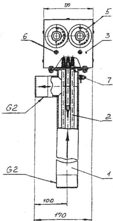
**Рис. 3. Электрический отопительный котел ЭОВ item 9/4,5**
